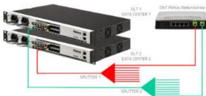
Figura 12. Proteção tipo C entre OLTs
